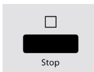
Pulse el botón **Stop** durante tres segundos, hasta que escuche una señal acústica y se apague un indicador de funcionamiento. Cuando el bloqueo está desactivado, el resto de los botones vuelven a activarse.
