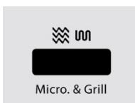
В данном режиме работы прибор работает в микроволновом режиме (55%) времени приготовления и в режиме гриля (45%) времени приготовления.
