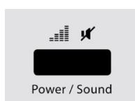
Premere il tasto **Potenza/Suono** per tre secondi, per attivare o disattivare il suono (segnale acustico). Messaggi di termine programma e segnali di avviso suoneranno anche con suono disattivato.
