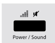
Druk 3 seconden op de knop **Vermogen/Sound** om de Sound (piepton) in of uit te schakelen. Beëindigingsberichten van de programma's en waarschuwingsignalen klinken ook bij uitgeschakelde sound.
