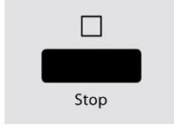
Drukt u de knop **Stop** lang in, totdat u een pieptoon hoort en de functie zichtbaar is in het display. In ontgrendelde stand zijn alle knoppen weer geactiveerd.
